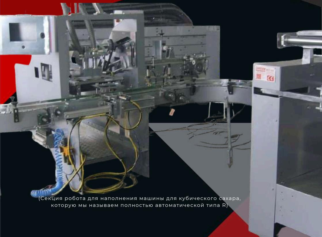
(Секция робота для наполнения машины для кубического сахара,
